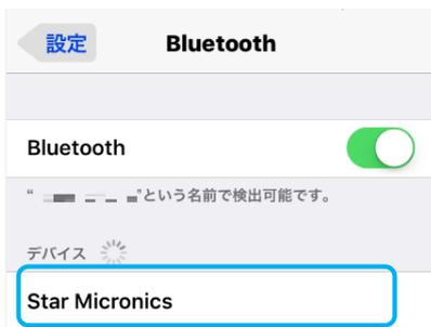
7. デバイス選択後、PIN を『1234』入力することでペアリングが開始されます。
